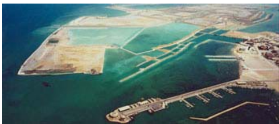
North Bahrain New Towns, Bahrain 2004 - 2008 Création de 650 ha de nouvelles îles par remblaiement hydraulique, protections, canaux AVP / PRO / DCE / DET (en association)
